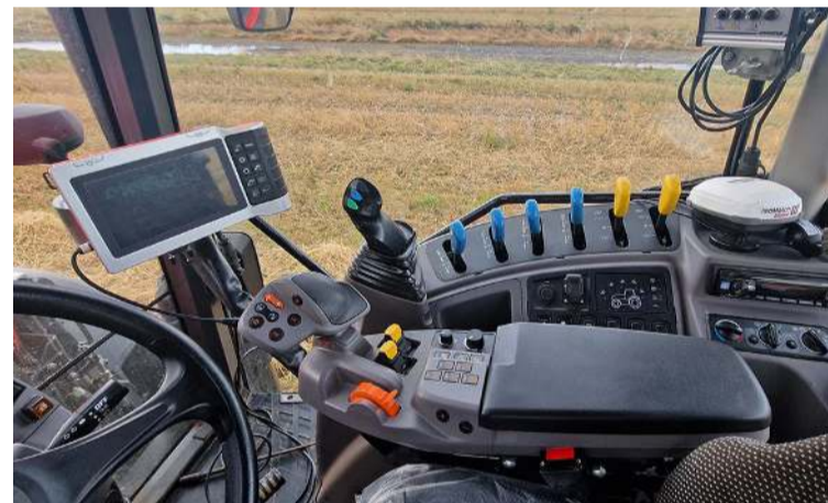
Hér er flóknum rafmagnsstýringum á vökvasneiðum fórnáð í nafni einfaldleika og áreiðanleika. Snertiskjár fyrir nákvæmar stillingar og Iso-Bus.
