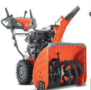
Snjóblásari ST327 9 HP, vinnslubreidd 69cm, hiti í handföngum, tveggja þrepa kerfi, framljós, extra stór dekk, rafstart.
