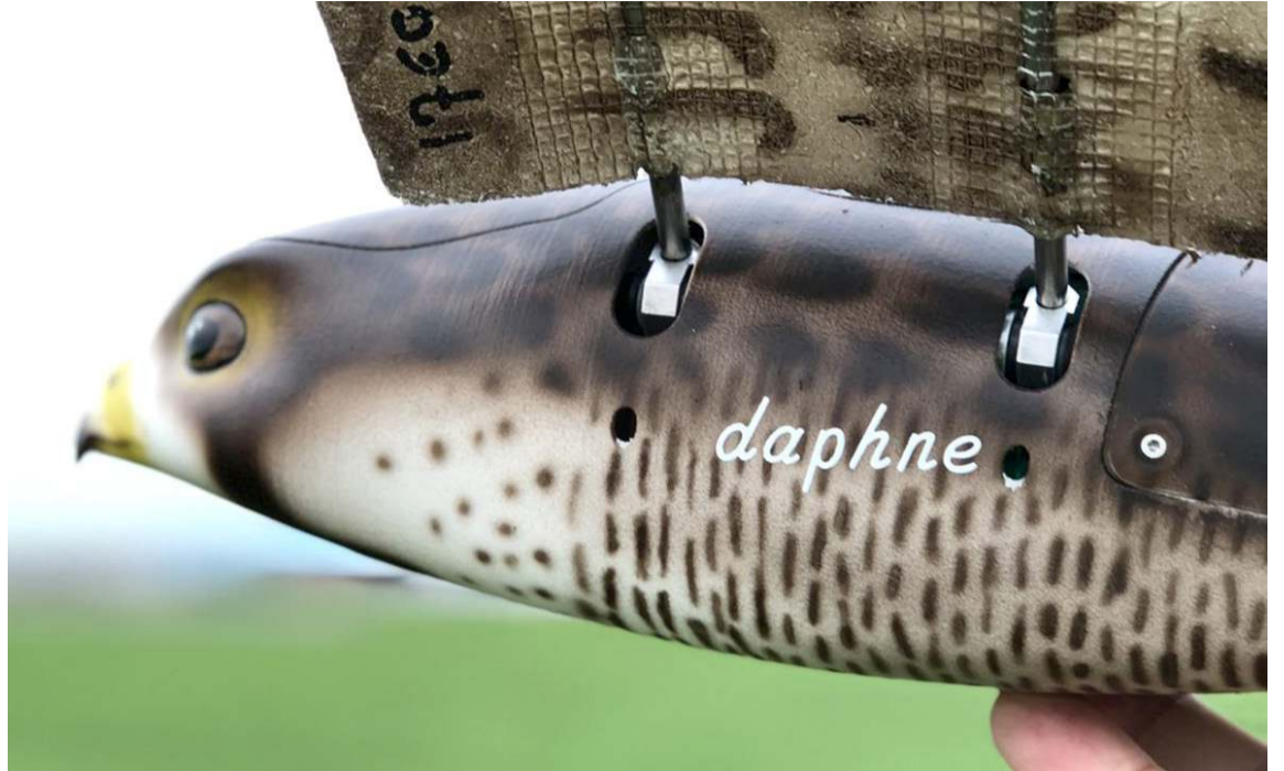
Fæling snýst um að valda fuglum óþægindum eða hræðslu svo þeir forðist ákveðin svæði. Fyrirtækið The Drone Bird Company hefur þróað sérstaka dróna sem ætlaðir eru til þess að verjast tjóni vegna ágangs fugla. Drónarnir líkjast ránfugli á flugi sem hægt er að nota með sjálfstýringu.
