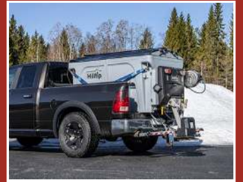
Hilltip Icestriker 900–1600L Salt og sanddreifari í tveim stærðum fyrir stóra pallbíl og minni vörubíla. Rafdrifinn 12V.
