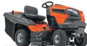
Traktor TC238T Sláttutraktor - 18 hestöfl
