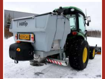
Hilltip Icestriker 600 TR Rafdrifinn kastdreifari fyrir dráttarvélur m/öflugum efnisskömmtunarbúnaði.
