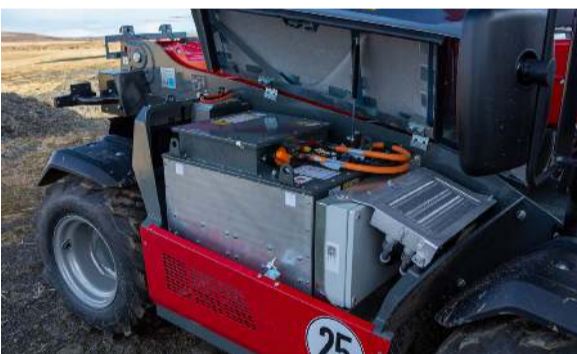
Undir húddinu er batterí í staðinn fyrir dísilmotor.
