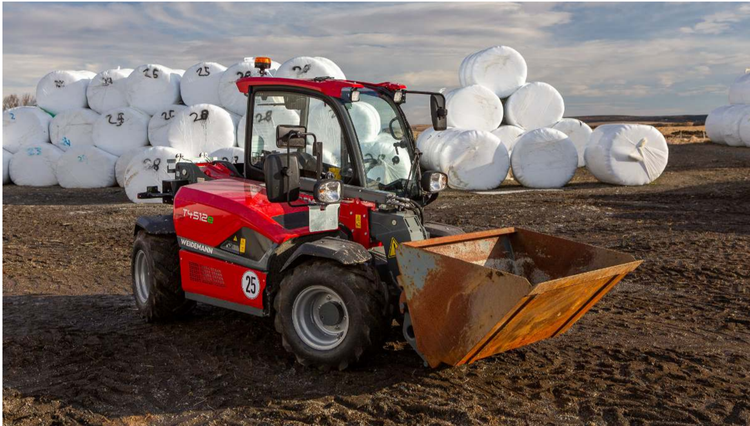
Weidemann T4512e er smár en knár. Þetta tæki getur gengið í flest störf á búinu á öruggari hátt en liðléttingar og er mun liprara en dráttarvél. Myndir / ÁL
