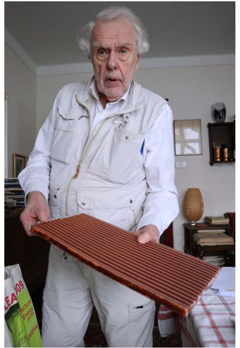
Loftræstieiningin Andandi gluggi var verðlaunuð árið 2018 sem besta loftræstikerfi heims. Jón heldur hér á varmaskipti gerðum úr 6 km af 1/10mm koparþræði, sem er kjarni einingarinnar.
