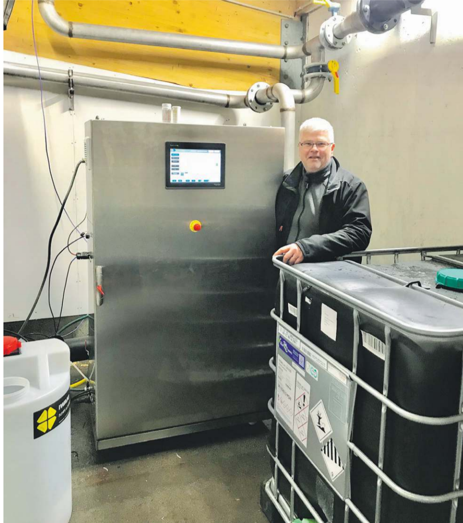
■ Erlendur Geir Arnarson framkvæmdastjóri Ísblik stendur við ECA búnað sem settur var upp hjá Búlandstindi á Djúpavogi. Búnaðurinn framleiðir 200 lítra á klukkustund af 5000 ppm ECA vatni sem síðan er blandað niður í 2-200 ppm eftir því hvar er verið að nota það í vinnslunni.
