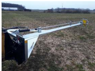
Glussadrifnar haughræur á ámoksturs- tæki eða 3 tengi. Hentar mjög vel fyrir úttanka, útilón og víðar. Lengdir: 4 m, 5 m, 6 m, 6,7 m, 8 m, 9 m. Rótor og skrúfa eru sambyggð, enginn öxull. Mjög léttbyggðar, 9 m löng er aðeins 360 kg. Allar festingar í boði fyrir skotbómulyftara og traktora. Boltaðar festingar sem er fljótlegt að skipta um. Getum einnig skaffað fremsta hlutann án burðarvirkis. Óflugur búnaður á góðu verði frá Póllandi. Hákonarson ehf. hak@hak.is - www.hak.is - S. 892-4163.
