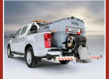
Hilltip Icestriker 380–550L Salt og sanddreifarari í tveim stærðum, fyrir minni pallbíla. Rafdrifinn 12V.
