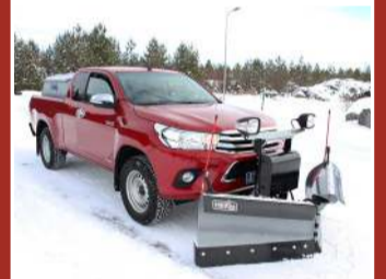
Hilltip Snowstriker VP Fjölplogur fyrir pallbíla, minni vörubíla og jeppa. Fáanlegur í 185–240 cm breidd.
