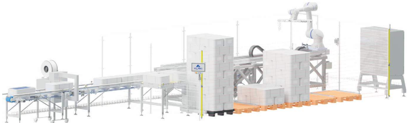
■ Meðal þess sem Klaki sérhæfir sig í eru sjálfvirknilausnir í pökkun og þar gegna róbótar lykilhlutverki.
