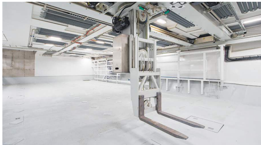
■ Hlaupaköttur í lest er fjarstýranlegur hvaðan sem er úr skipinu.
