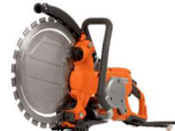
Husqvarna K7000 Ring rafmagnssög Sögunardýpt 32,5 cm
