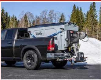
Hilltip Icestriker 900-1600L Salt og sanddreifari í tveim stærðum fyrir stóra pallbíla og minni vörubíla. Rafdrifinn 12V.
