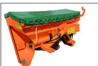
Salt- og sanddreifari HZS-10, 1 m3, glussadrifin, með klumpabryt og tjakk
