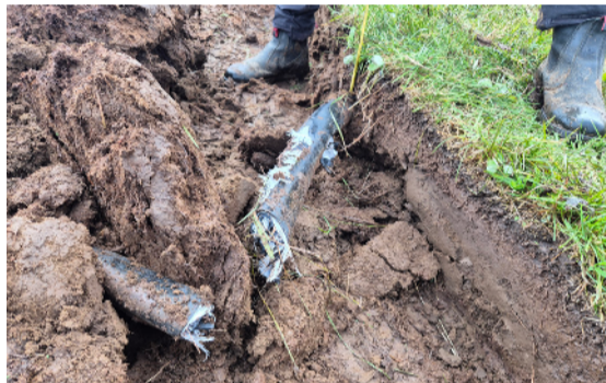
„Gott dæmi er þegar við plægðum með venjulegum teigplög (20 cm vinnsludýpt) í sundur stofnrafmagnslögnina sem veitir rafmagn á Hvanneyri og Borgarnes.“
