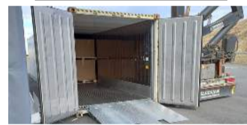
Rampar fyrir frysti/kæligáma á lager. Burðargeta 10 tonn. Dekkplata 10 mm, L 170 cm x B- 200 cm x hæð 21 cm. Heitgalvaniserað stál. Lyftaratækur á þrjú vegu. Eigum einnig rampa fyrir hefðbundna sjögáma. Hákonarson ehf. www.hak.is s. 892-4163 hak@hak.is
