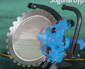
Tyrolit Ringsaw TR40 Steinsög - rafknúin Sögunardýpt 30cm
