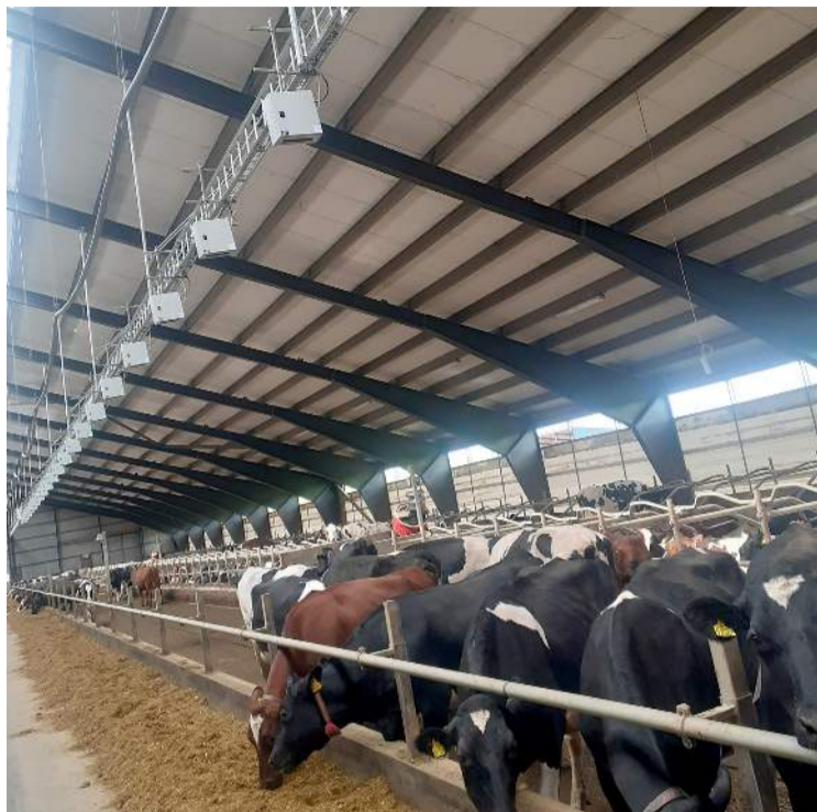
Úr fjósi í Danmörku. Myndavélar eru festar yfir fóðurgang í fjósi og eru partur af CFIT-kerfinu. Það tekur myndir af kúnum og fóðrinu við fóðurganginn en með því er metið hve mikið hver kýr étur, sem eru verðmætari upplýsingar bæði í bústjórn og til að meta fóðurnýtingu einstakra kúa.
