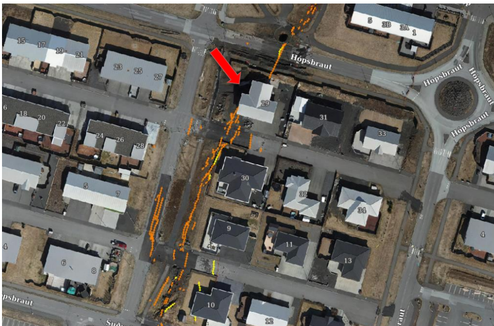
Mynd 1. Skjáskot af sprungusjá. Húsið sem unnið var við liggur þvert yfir stærstu sprunguna í gegnum bæinn. Þess ber að geta að holan sem myndaðist í vinnuslysnu er utan við sýnilegu línuna sem sést hverfa undir húsið.
